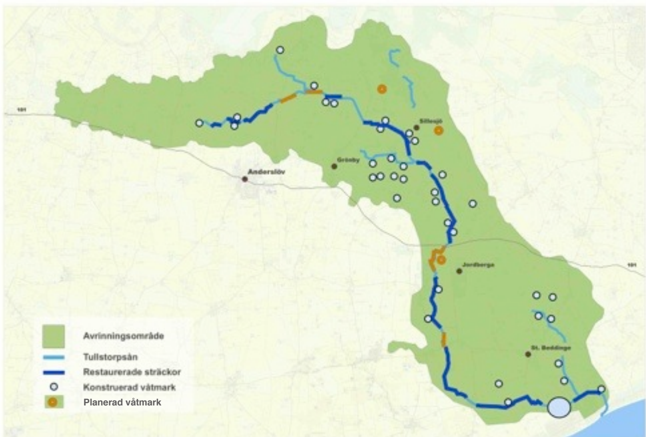
Tullstorpsåns avrinningsområde med restaurerade åsträckor, konstruerade respektive planerade våtmarker
