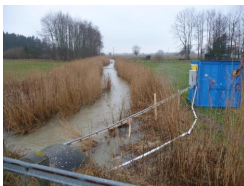
Föreningens flödesstyrda provtagningsstation vid Ängarödsbron i den nedre delen av ån.
